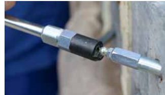
DESOL Snappy auf den Kegelnippel schieben, Sicherheitssteg unten | Pousser le DESOL Snappy sur le nipple à tête ronde (barre de sécurité en bas)
