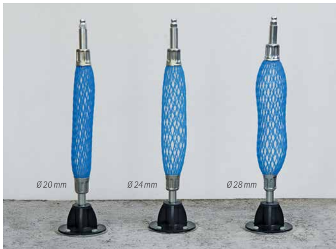
Druckvorratsschlauch mit Klebepacker gesetzt; (von links) Ø 20 mm: ca. 1,5 bar, Ø 24 mm: ca. 2 bar, Ø 28 mm: ca. 5 bar | Tuyau d'injection automatique avec injecteur à coller (de gauche) Ø 28 mm: 5 bar, Ø 24 mm: 2 bar, Ø 20 mm: 1,5 bar
