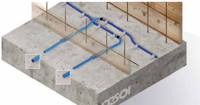
① Befüll- und Entlüftungssystem mit Injektionsschlauch ① Système de remplissage et de désaération avec tuyau d'injection
