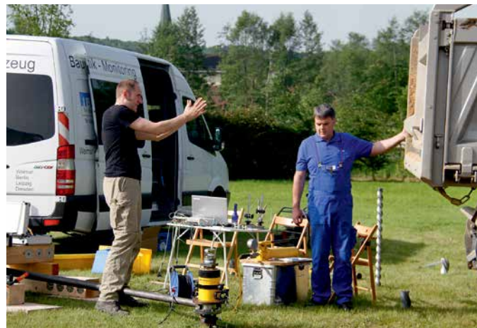
Pfahlprobelbelastung im Versuchsfeld | Charge d'essai sur pieux dans le champ d'essai
